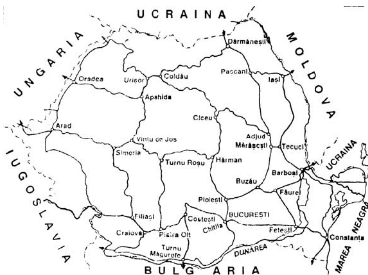
Figura 6.5. Poligoanele rețelei de nivelment de ordin I, în sistemul „zero Marea Neagră 1975”
